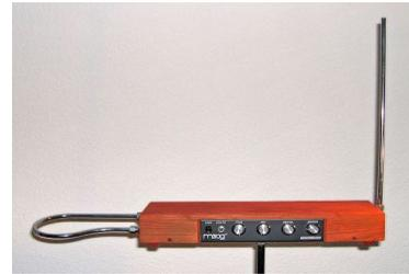
L'instrument possède également des oscillateurs qui permettent de contrôler la fréquence et le volume. Les signaux électriques produits par le thérémine sont amplifiés par l'appareil et le son est émis par un haut-parleur. L'instrument est tout d'abord vu comme une curiosité. En 1922, présenté à Lénine, il l'impressionne et est promu en URSS.
