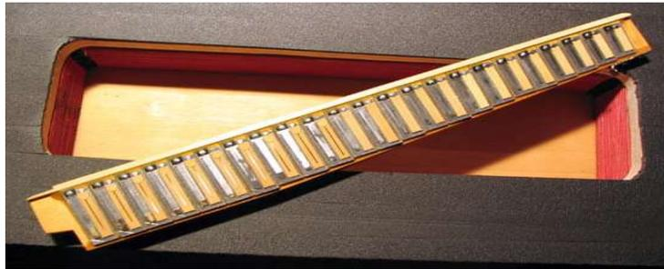
Côté mécanique, l'appui d'un bouton actionne un bras métallique qui va déclencher l'ouverture d'une soupape ; grâce au mouvement simultané du soufflet, l'air peut alors passer à l'intérieur de l'accordéon par cette soupape. L'anche associée va alors être mise en action, et produire le son.
